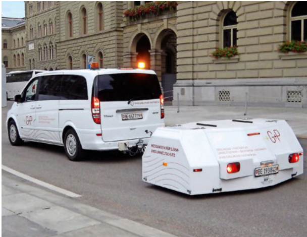
1 | Messanhänger (links), ein Reifen und zwei Mikrofone (rechts) und schematische Darstellung der CPX-Messung (unten).
